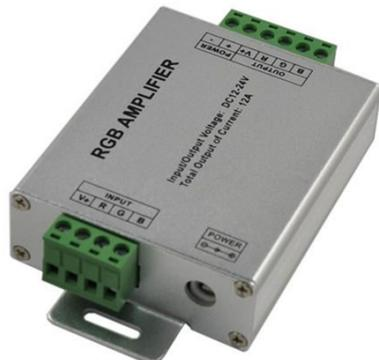
Cet amplificateur 12/24V 12A s'intercale entre la sortie du contrôleur RGB et les bandes leds. La puissance de sortie d'un contrôleur étant limitée, l'ajout d'un ou plusieurs amplificateurs permet de piloter un grand nombre de strips, quelque soit sa puissance totale.
